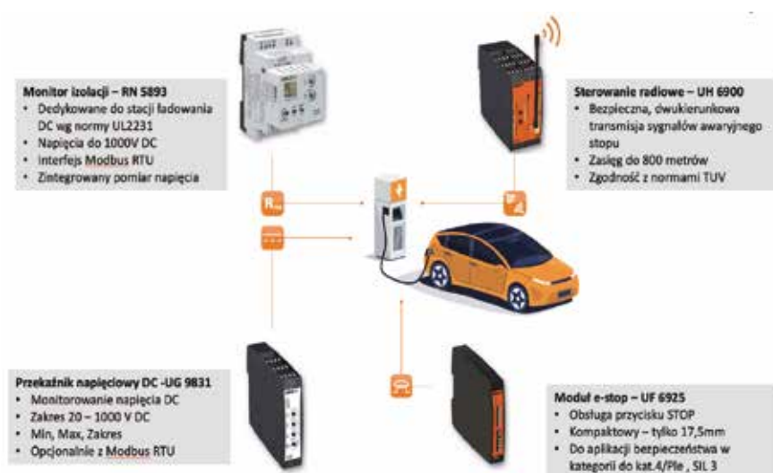
Rys. 3. Przykład architektury szybkiej stacji ładowania DC z układami monitorowania izolacji i bezpieczeństwa
