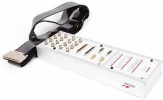
Rys. 2. Moduł dSpace zawierający kartę DS1104 [źródło: Artisan TG]
